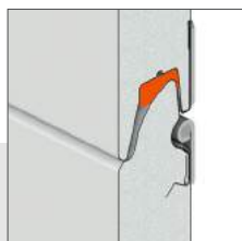
Panel grubości 40 mm. U=1,12 [ W/m^2K ]*.
